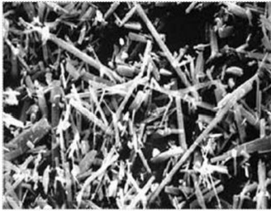
Micrografía de la wollastonita \text{CaSiO}_3 , mostrando su forma acicular característica.
